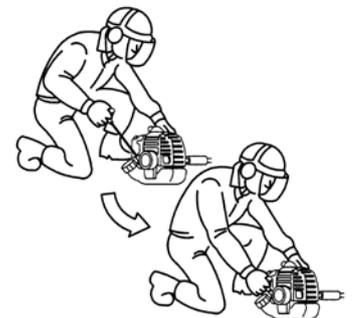
⑤ エンジンが始動したら、トリガースロットルレバーを操作せずに(アイドル位置のまま)、1~2分間暖機運転をしてください。
