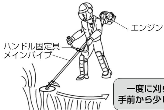
■ 刈刃が石等の硬いものに衝突したときは、すぐにエンジンを停止して刈刃を点検し、損傷のある場合は交換してください。また繰り返し衝撃を受けると、刈刃の損傷だけでなく、ギヤケースを破損する危険があります。
