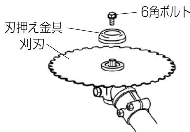
■ エンジン回転が低いままで作業すると、クラッチの異常加熱により故障の原因となります。チップソー等金属製の刈刃使用時は、エンジン全開回転速度の7~8割程度、ナイロンローター使用時は、エンジン回転速度を全開にして作業を行ってください。
