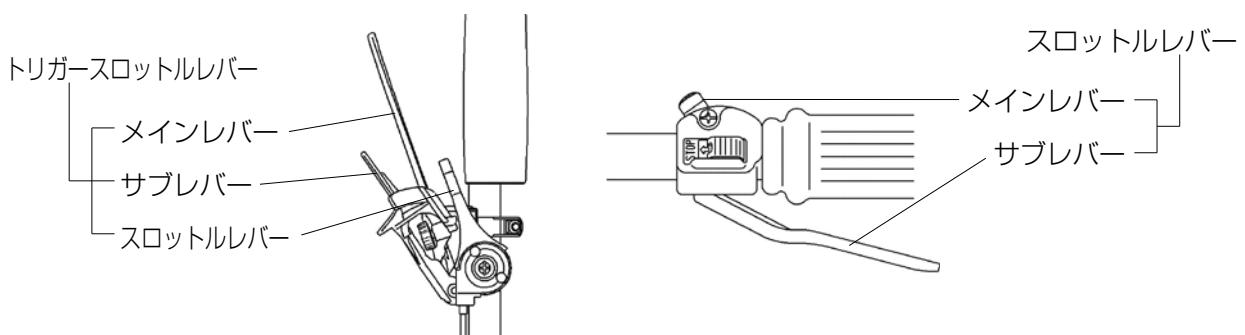
トリガースロットルレバー／スロットルレバーを操作せずアイドリング位置のまま
