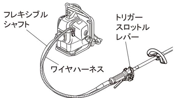
**メモ**：実際の使用状態に近づけてスロットルワイヤの遊び調整をするためです。フレキシブルシャフトの曲げ具合も実際の使用状態を想定して曲げてください。
