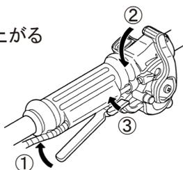
開回転速度の7～8割程度、ナイロンローター使用時は、エンジン回転速度を全開にして作業を行ってください。
