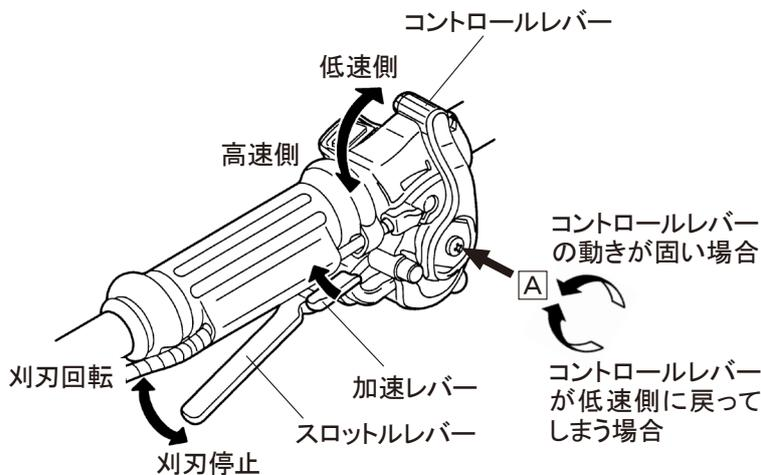
**メモ**：チップソーなど、金属刃使用の草刈作業では、エンジン全開回転速度の7～8割程度で行ってください。密生した草を刈るときやナイロンローター使用時はコントロールレバーを高速側いっばいに調整し、エンジン回転を上げてください。
