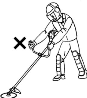
■ 刈刃(金属刃)の動かし方は、右から左に操作してください。逆に左から右へ操作すると[キックバック]により危険な現象が起きます。この操作は、しないでください。
