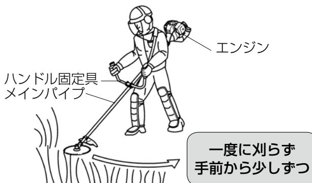
■ 刈刃が石等の硬いものに衝突したときは、すぐにエンジンを停止して刈刃を点検し、損傷のある場合は交換してください。また繰り返し衝撃を受けると、刈刃の損傷だけでなく、ギヤケースを破損する危険があります。
