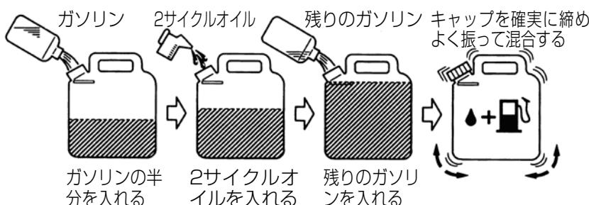
〈2〉燃料タンクに混合燃料を少しづつ、ゆっくりと入れてください。混合燃料は燃料タンクいっぱいに入れないで、8分目（給油口先端より約2cm）を目安にしてください。
