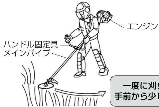
■ 刈刃が石等の硬いものに衝突したときは、すぐにエンジンを停止して刈刃を点検し、損傷のある場合は交換してください。また繰り返し衝撃を受けると、刈刃の損傷だけでなく、ギャケースを破損する危険があります。
