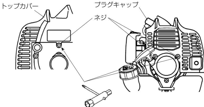
③ トップカバーを上に引き上げて取り外し、各部を清掃してください。
