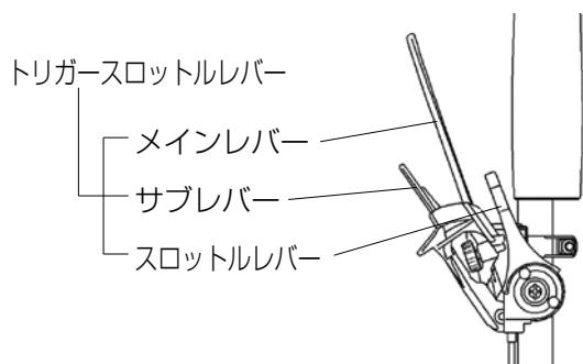
トリガースロットルレバー／スロットルレバーを操作せずアイドリング位置のまま
