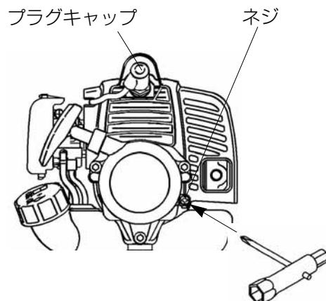
④ トップカバーを上に引き上げて取り外し、各部を清掃してください。
