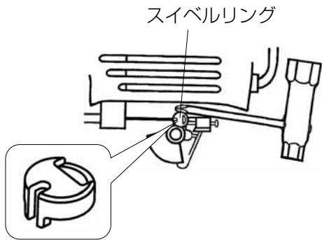
② 扇形状部品を左へ回転させ、ワイヤエンドを外してからスロットルワイヤ (アウタ) をガイドから外します。
