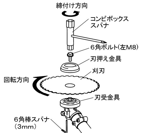
**注意** 刈刃の取付け穴が刃受金具の凸部からずれていないことを確認してください。ずれている場合は刈刃を取り付け直してください。正しく取り付けしていないと異常振動し、ケガや機械の故障の原因になります。刈刃を手で回し、刈刃のプレが無いことを確認してください。
