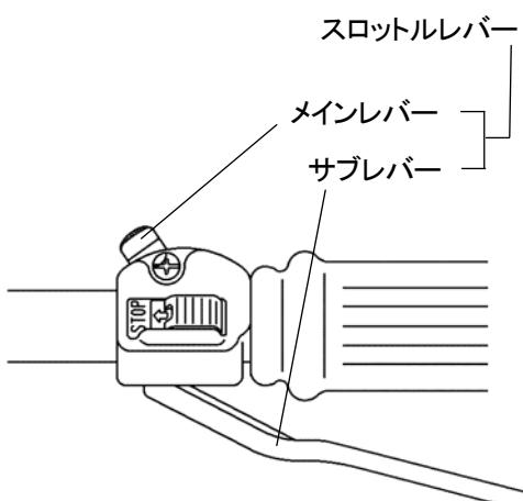
トリガースロットルレバー／スロットルレバーを操作せずアイドリング位置のまま
