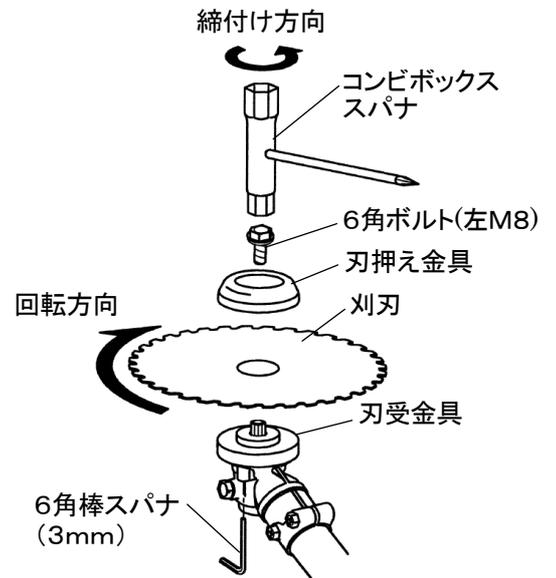
**注意** 刈刃の取付け穴が刃受金具の凸部からずれていないことを確認してください。ずれている場合は刈刃を取り付け直してください。正しく取り付けしていないと異常振動し、ケガや機械の故障の原因になります。刈刃を手で回し、刈刃のブレが無いことを確認してください。
