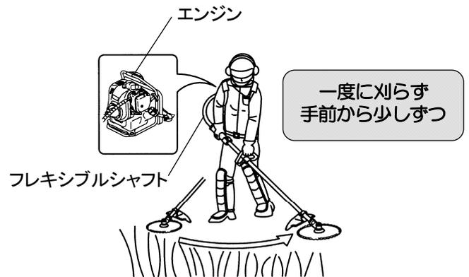
■ 刈刃が石等の硬いものに衝突したときは、すぐにエンジンを停止して刈刃を点検し、損傷のある場合は交換してください。また繰り返す衝撃を受けると、刈刃の損傷だけでなく、ギヤケースを破損する危険があります。
