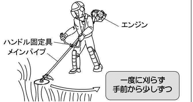
■ 刈刃が石等の硬いものに衝突したときは、すぐにエンジンを停止して刈刃を点検し、損傷のある場合は交換してください。また繰り返し衝撃を受けると、刈刃の損傷だけでなく、ギャケースを破損する危険があります。
