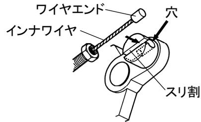
③ スロットルワイヤの取り付けが終わったら必ずメインレバー、サブレバーを操作し、動作の確認を行ってください。メインレバー、サブレバーを手から離れた際、キャブレタの扇状部品がアイドルスクリューに接している事を確認してください。扇状部品とアイドルスクリューの間にすき間がある場合、スロットルワイヤ(アウト)がスロットルレバーの穴の奥まで入っていない可能性があります。再度ワイヤの取り付けを確認してください。
