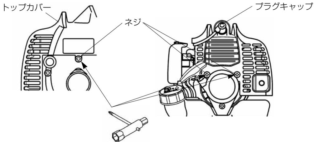
④ トップカバーを上へ引き上げて取り外し、各部を清掃してください。
