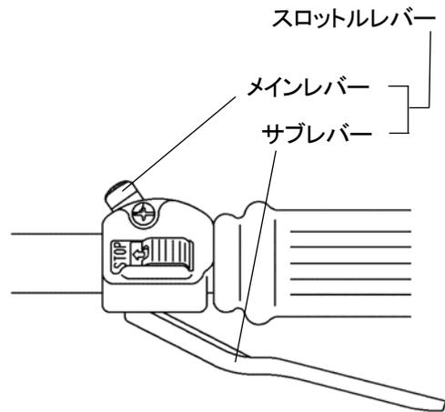
トリガースロットルレバー／スロットルレバーを操作せずアイドリング位置のまま
