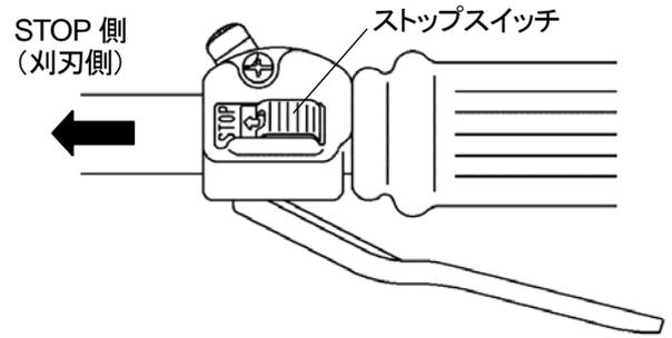
**注意** ・ここで実作業に入る前に、〈2〉停止の項に従って、ストップスイッチを STOP 側にしてエンジンが停止することを確認し、始動・停止の練習をしてください。
