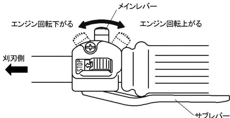
③, ④ メインレバーを戻す、またはサブレバーを離しアイドリングにすると、エンジン回転はアイドリング状態になります。刈刃はしばらく惰性で回転した後、停止します。刈刃の回転が止まらない場合はアイドリング調整をしてください。
