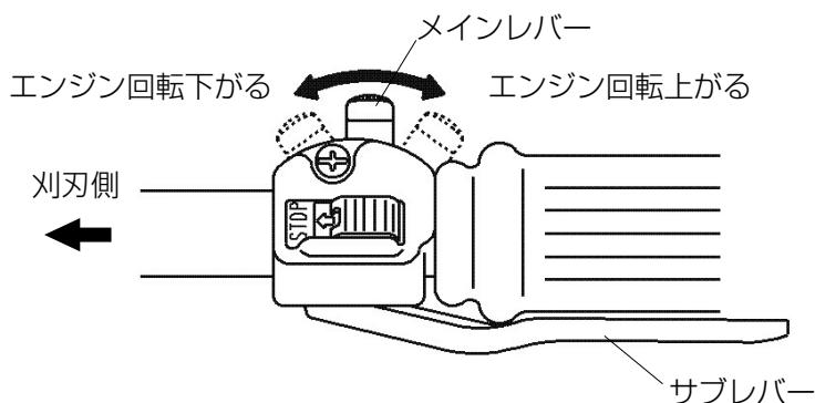
③, ④ メインレバーを戻す、またはサブレバーを離すと、エンジン回転はアイドリング状態になります。刈刃はしばらく惰性で回転した後、停止します。刈刃の回転が止まらない場合はアイドリング調整をしてください。
