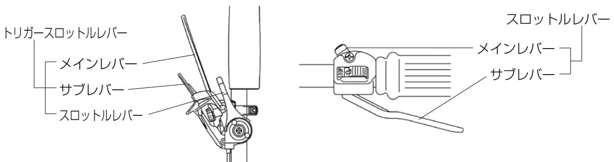
トリガースロットルレバー／スロットルレバーを操作せずアイドリング位置のまま
