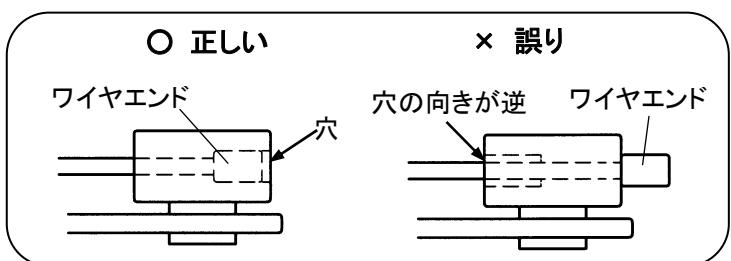
\*下図のように、ワイヤエンドがスリ割の穴に届かない場合、スロットルワイヤ(アウタ)がガイド部分から外れている、もしくはスロットルワイヤ(アウタ)とガイド部分端面にスキマがある事が考えられます。スロットルワイヤ(アウタ)を刃刃側に押し込んでから再度取付けを行ってください。
