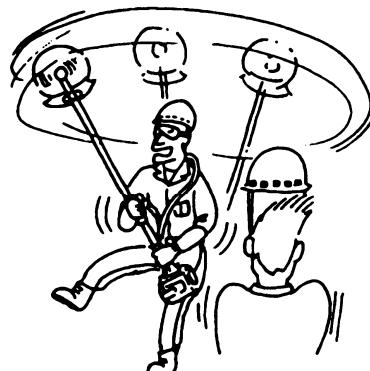
■ 刈刃(金属刃)の動かし方は、右から左に操作してください。逆に左から右へ操作すると [キックバック]により危険な現象が起きます。この操作は、しないでください。
