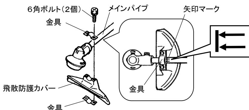
① メインパイプの矢印マークの位置に、飛散防護カバーを図のように上下から金具ではさんでください。
