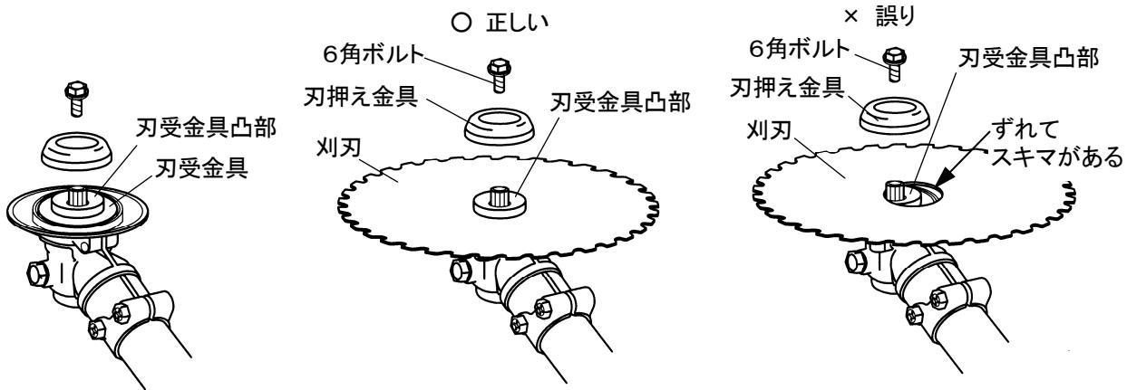
**！警告** 作業前には必ず、刈刃取付け用の6角ボルトと刃押え金具の摩耗を点検してください。
