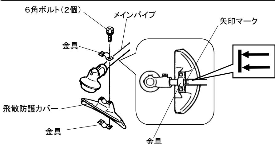
① メインパイプの矢印マークの位置に、飛散防護カバーを図のように上下から金具ではさんでください。
