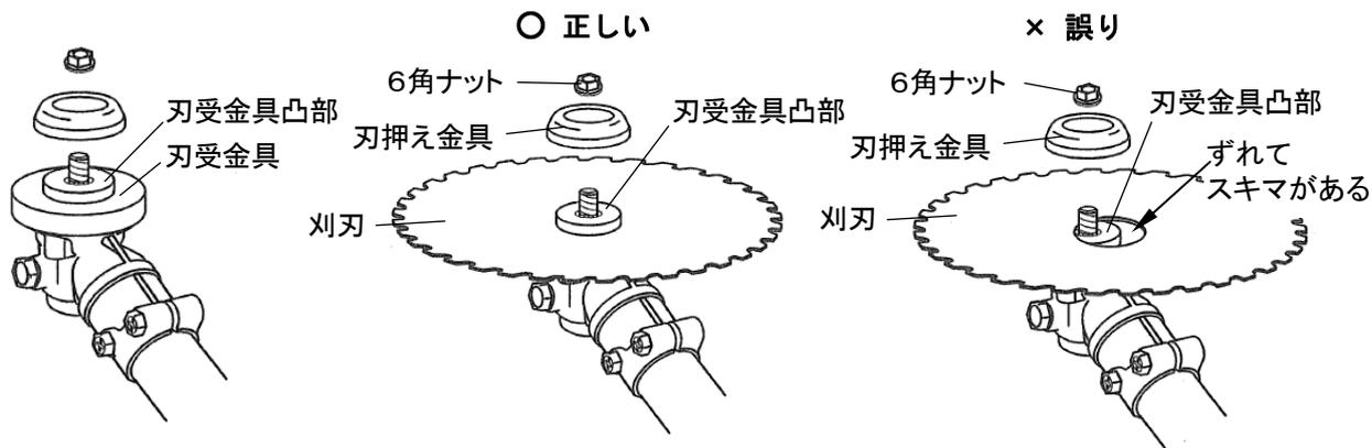
**警告** 作業前には必ず、刈刃取付け用の6角ナットと刃押え金具の摩耗を点検してください。
