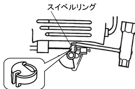
② 扇形状部品を左へ回転させ、ワイヤエンドを外してからスロットルワイヤ（アウト）をガイドから外します。
