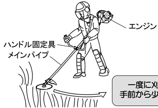
■ 刈刃が石等の硬いものに衝突したときは、すぐにエンジンを停止して刈刃を点検し、損傷のある場合は交換してください。また繰り返し衝撃を受けると、刈刃の損傷だけでなく、ギャケースを破損する危険があります。
