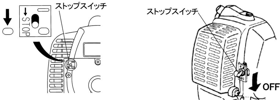
【 BC20MA ,BC23MA ,BC23MAL ,BC23MAG ,BC26MA ,BC26MAL 】
