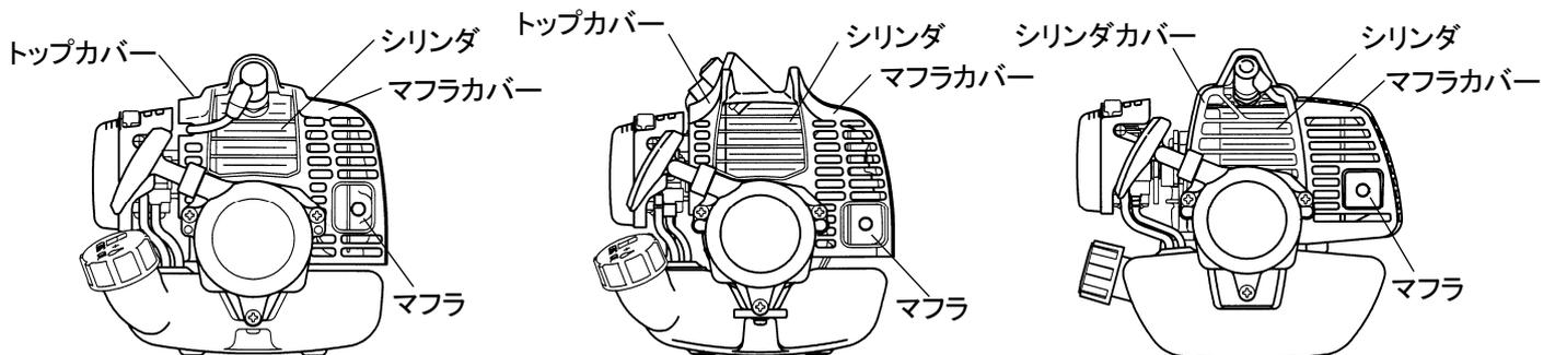
【 BC20MA ,BC23MA ,BC23MAL ,BC23MAG 】 【 BC26MA ,BC26MAL 】
