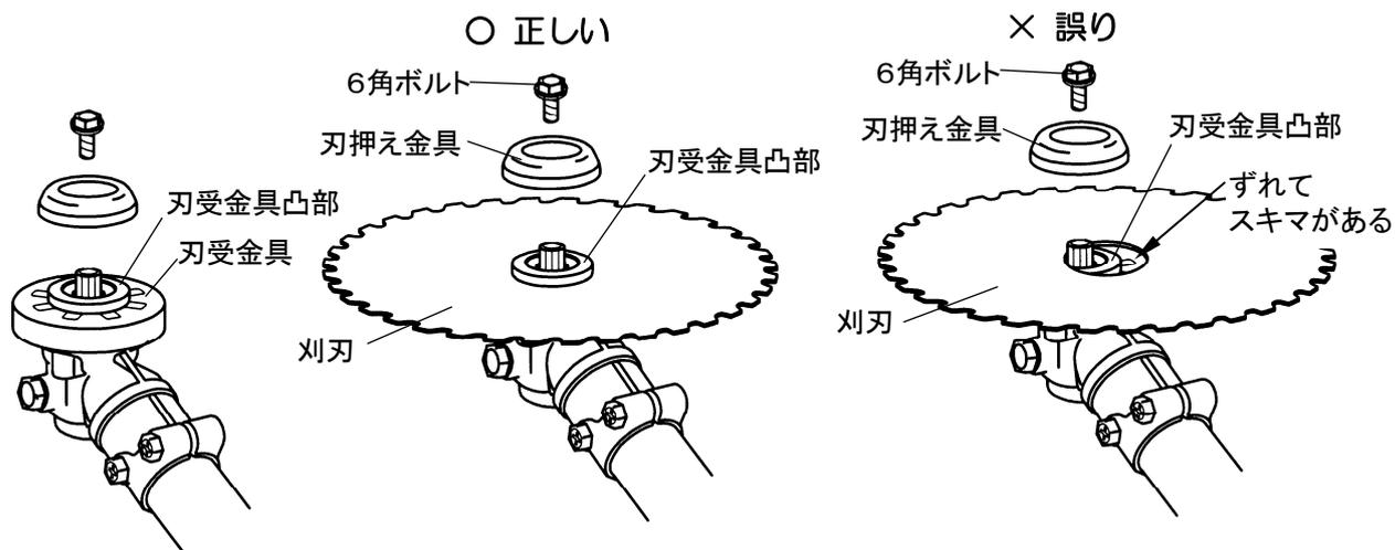
**警告** 作業前には必ず、刈刃取付け用の6角ナットと刃押え金具<sup>※1</sup> / 6角ボルトと刃押え金具<sup>※2</sup>の摩耗を点検してください。
