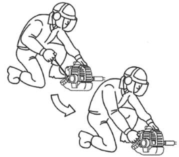
⑥ エンジンが始動したら、スロットルレバーを低速回転側いっぱい(アイドリング位置)に戻し、1~2分間暖機運転をしてください。
