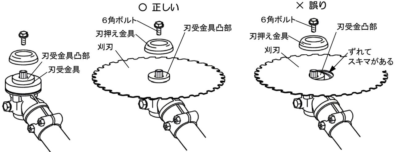
**警告** 作業前には必ず、刈刃取付け用の六角ボルトと刃押え金具の摩耗を点検してください。
