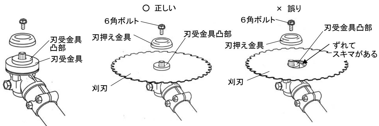
**！警告** 作業前には必ず、刈刃取付け用の6角ボルトと刃押え金具の摩耗を点検してください。
