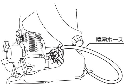
ノズル、ノズルパイプ、サキコック、噴霧ホースの順で接続し、ホースの反対端は噴霧機の吐出口に接続します。
