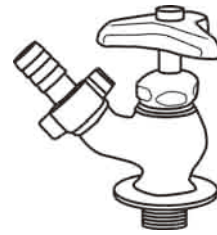
ホース接続散水栓
