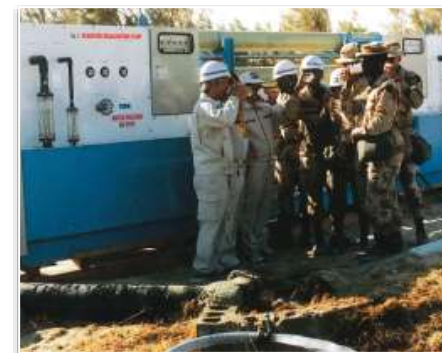
災害時緊急給水RO
